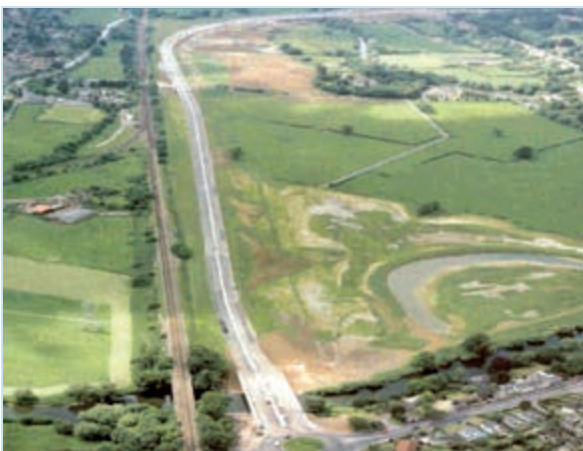
איור 6.1: תכנון נופי שפעל להבטיח התאמה מרבית של תוואי הכביש המהיר לתבליט: במעקף A4/A46 ליד העיר באת' שבאנגליה נעשה שימוש רב בדירוג, בחפירות דמה ובסוללות נמוכות כדי למסך את התנועה ולמזג את השיפועים בעדינות בנוף הסובב. (צילום: EU: Highways Agency, UK)
