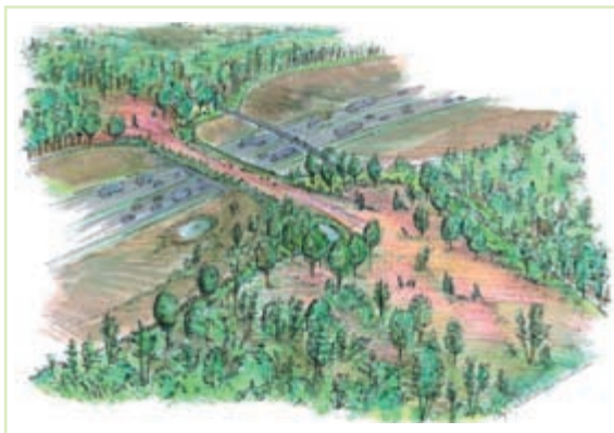
איור 7.12: דוגמה לתכנון מעברים עיליים: הפרדה בין תפקודים המיועדים לבעלי חיים ולבני אדם (המעבר הצר מימין) ויצירת שטח פתוח ומגוון בתי גידול בכניסה למעבר רצף. (NL)
